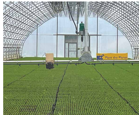
RTU pētnieki veic vizuālo datu ierakstīšanu ar industriālo digitālo kameru, kas ir piestiprināta uz laistīšanas iekārtas (SIA "Rīgas meži" siltumnīca "Norupe").
