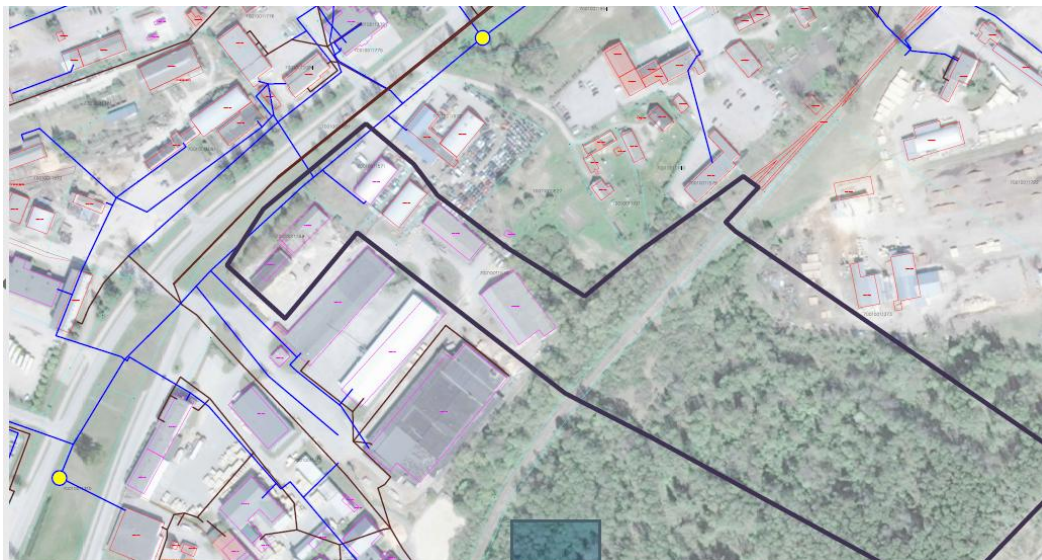
9.att. Tuvākie centralizētās ūdensapgādes tīkli un hidranti
